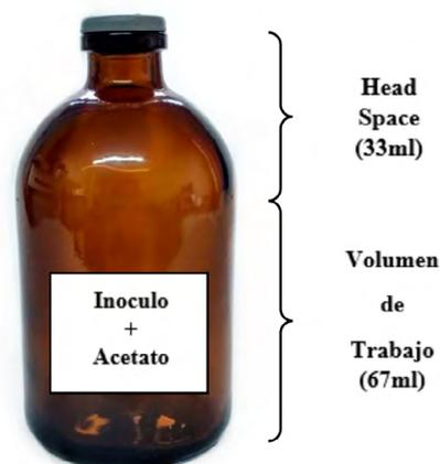
Figura 2 | Esquema del reactor de ensayo. Fuente: Los autores
